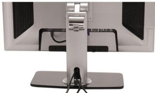
Nachdem Sie alle notwendigen Kabel an Ihren Monitor und Computer angeschlossen haben (siehe [Einrichten Ihres Monitors](#) für Informationen über das Anschließen von Kabeln), verwenden Sie die Auslassung für die Kabelverlegung, um alle Kabel wie oben gezeigt zu verstauen.
