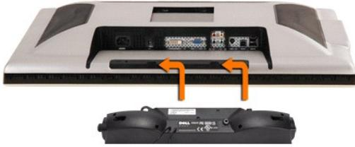
**HINWEIS:** Der Soundbar-Netzanschluss (12 V Gleichstromausgang) ist ausschließlich für die optionale Dell Soundbar bestimmt.
