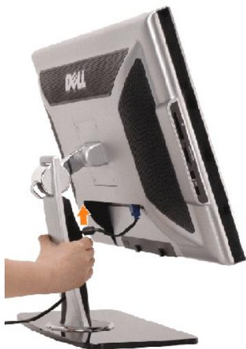
1. Halten Sie die Kabelabdeckung fest und drücken sie leicht gegen den Fuß. Schieben Sie vorsichtig die Kabelabdeckung aufwärts, um sie von dem Fuß zu entfernen.
